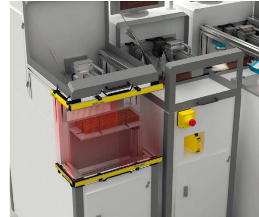
Nebezpečné místo v dosahu rukou je chráněné bezpečnostním světelným závěsem MiniTwin
