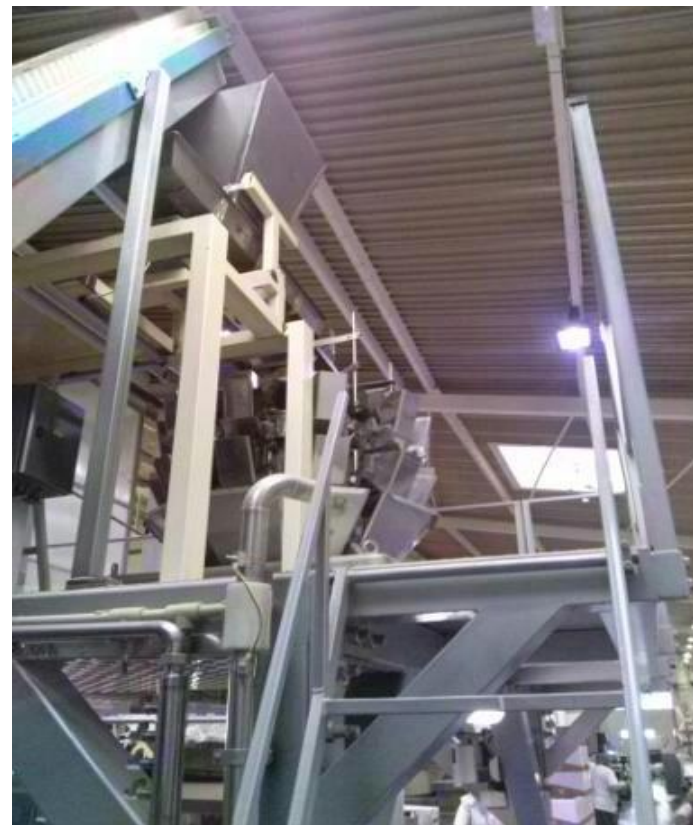
Pevně zabudovaný žebřík bez přesahu 1,1 m
