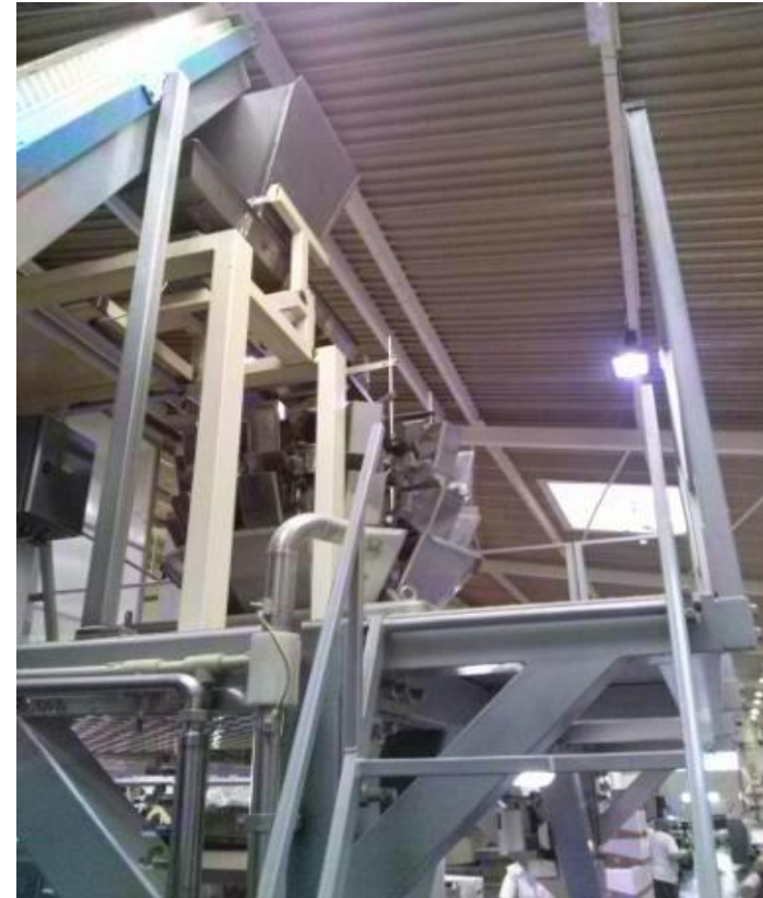
Pevně zabudovaný žebřík bez přesahu 1,1 m
