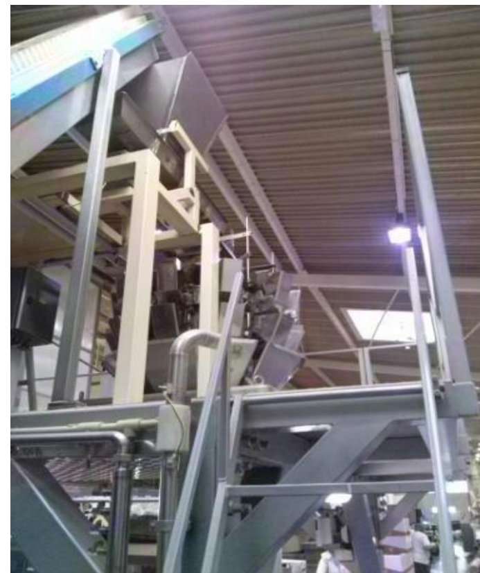
Pevně zabudovaný žebřík bez přesahu 1,1 m
